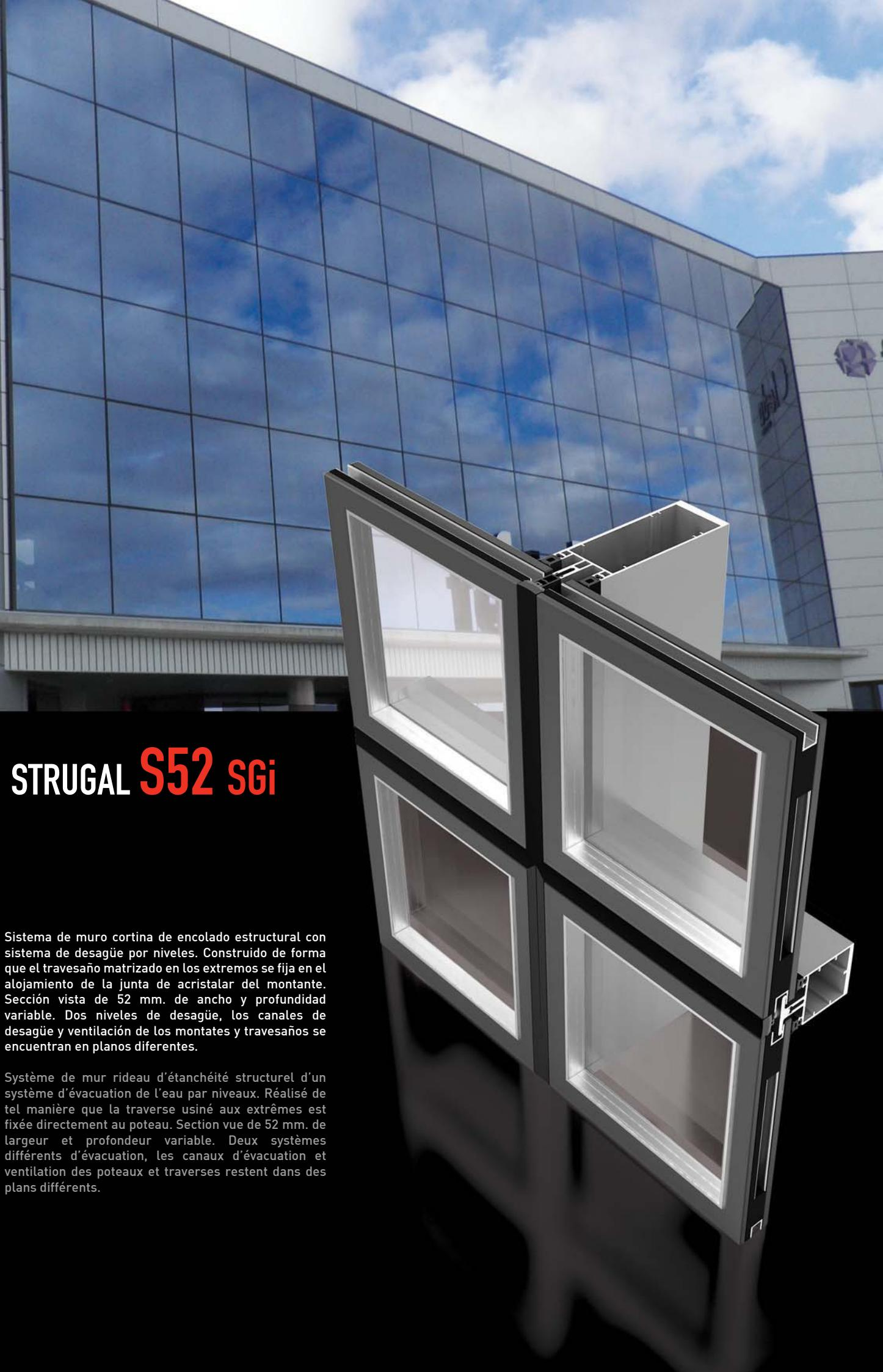
Sistema de muro cortina de encoldado estructural con sistema de desagüe por niveles. Construido de forma que el travesaño matrizado en los extremos se fija en el alojamiento de la junta de acristalar del montante. Sección vista de 52 mm. de ancho y profundidad variable. Dos niveles de desagüe, los canales de desagüe y ventilación de los montates y travesaños se encuentran en planos diferentes.
