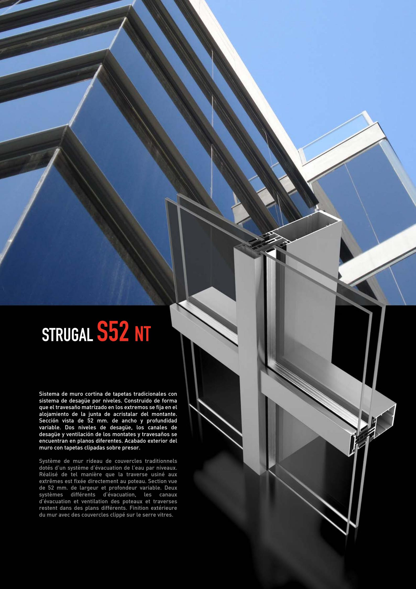
Sistema de muro cortina de tapetas tradicionales con sistema de desagüe por niveles. Construido de forma que el travesaño matrizado en los extremos se fija en el alojamiento de la junta de acristalar del montante. Sección vista de 52 mm. de ancho y profundidad variable. Dos niveles de desagüe, los canales de desagüe y ventilación de los montantes y travesaños se encuentran en planos diferentes. Acabado exterior del muro con tapetas clipadas sobre presor.
